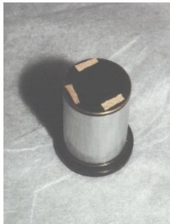
Foto XXXIX Afwijkende plaatsing van de oculairmicrometer tbv. fotografie
